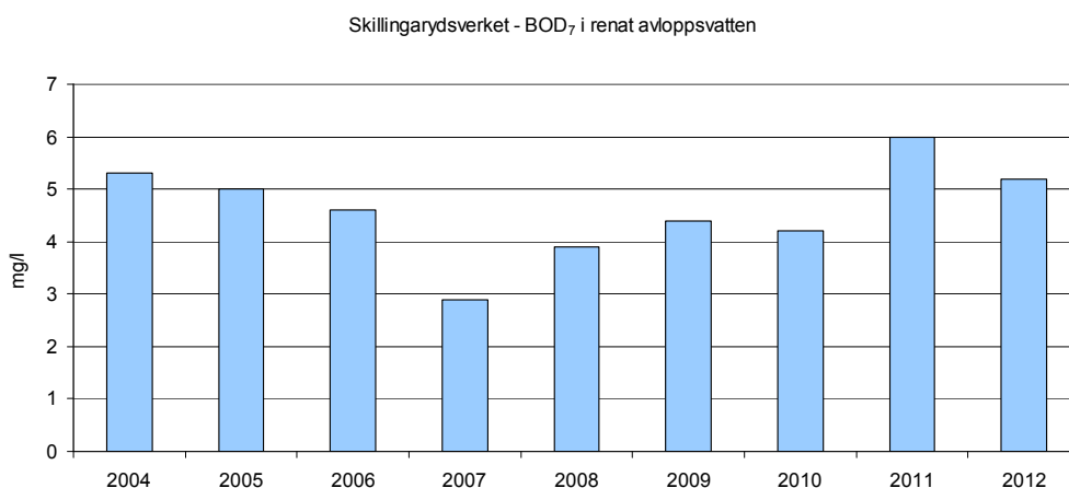
Figur. BOD 7 i renat avloppsvatten i Skillingarydsverket. Riktvärdet är 10 mg/l. Källa: Tekniska kontoret
