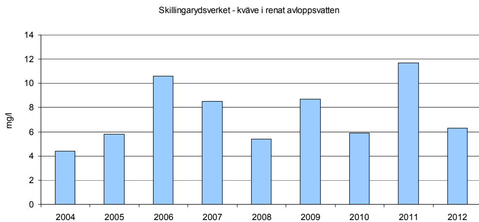
Figur. Kvävehalt i renat avloppsvatten i Skillingarydsverket. Riktvärdet är 15 mg/l. Källa: Tekniska kontoret
