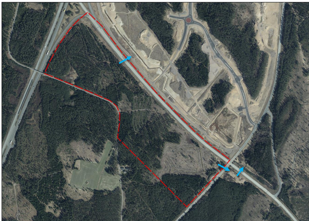
Figur 5. Placering, inklusive strömningsriktning, av planområdets anslutande trummor.
